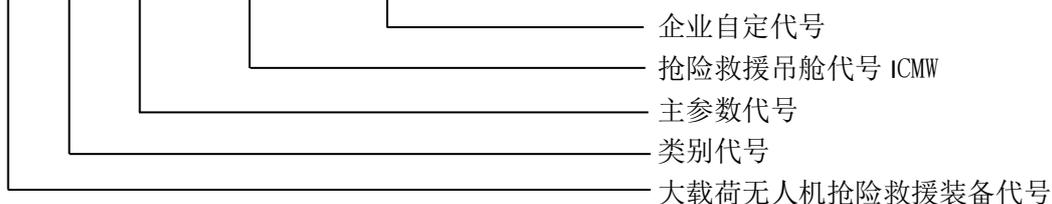
示例1：某企业生产的大载荷无人机抢险救援装备的型号为 DRE-E125-ICMW，表示该产品配备的大载荷无人机的动力源类型是电动型、有效载荷为 125 kg，没有企业自定义代号。
